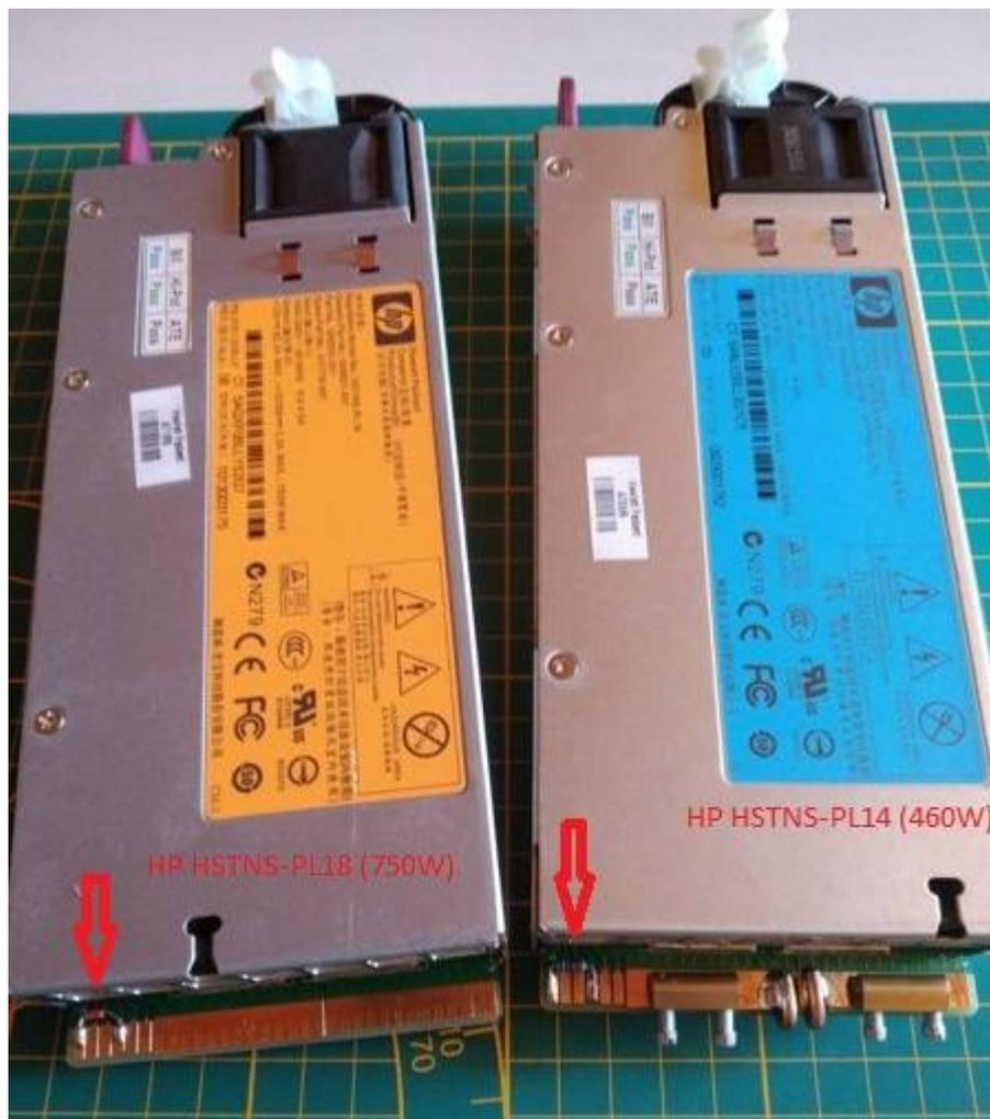
Um das Netzteil nach dem Anstecken starten zu lassen wird einfach zwischen dem ersten und vierten Pin eine Brücke gelötet. Man liest manchmal davon, einen Widerstand um die 500 Ohm (330, 560) zu verwenden, ich hab beides in Einsatz, wer also keinen passenden Widerstand hat, lötet eine Brücke.
