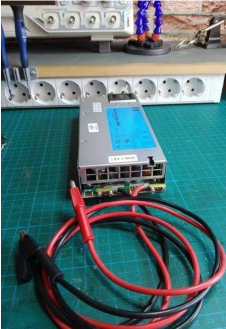
Als Abgang löte ich normalerweise Silikonleitungen (so ab AWG10, je nach Last) an, manchmal sieht man auch aufgelötete oder durchgebohrte Bananenbuchsen. Beim Durchbohren bitte vorher vergewissern, dass es keine Mutilayer-Platine mit Massefläche ist (ich hab bisher noch keine Probleme gesehen, aber wer weiß, was Modelländerungen mit sich brachten). In obigen Beispiel hab ich einfach zwei abisolierte Lüsterklemmen draufgelötet.
