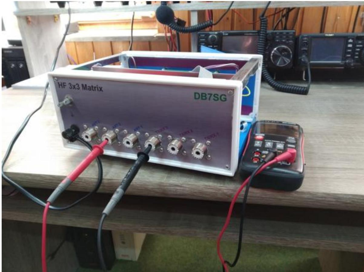
Die Impedanz und das SWR wurden durch alle Möglichen Schaltkombinationen über den Bereich 0 - 50MHz gegen einen Dummyload gemessen. Die Impedanz liegt im Messbereich immer um 50 Ohm, Das SWR geht gegen 1 und hebt sich Richtung 50 MHz leicht auf 1,04.
