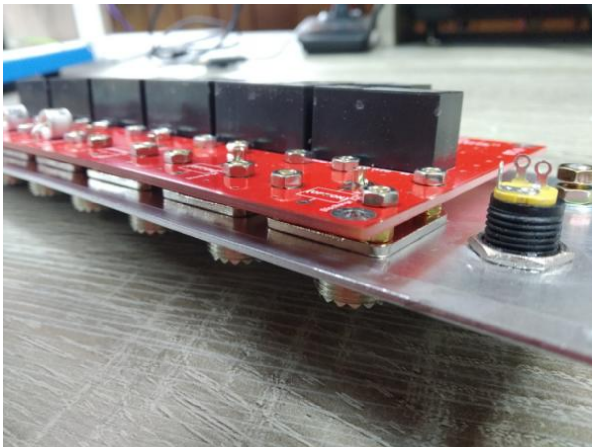
Das Relaisboard wird an der Rückplatte mit Messing-M3-Spacern (StandOffs) verschraubt.
