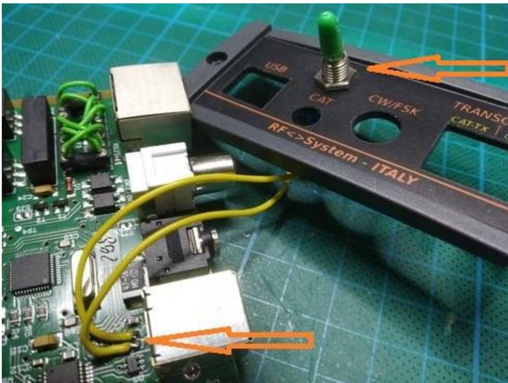
Als Schalter hab ich einen Mini-Kippschalter in die Rückseite gebohrt (einfacher als einen rechteckigen Wippschalter zu fräsen), die Stelle über der CAT-Buchse ist die einzige Stelle, die bequem Platz bietet und beim Zusammenbau nicht großartig stört...
